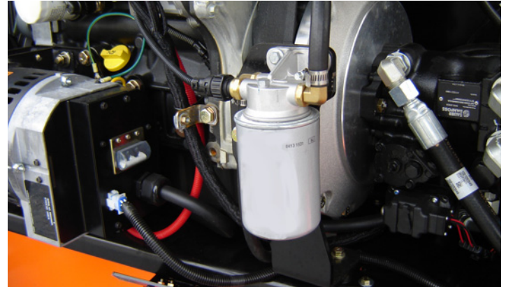
C. Brandstoffilter – Deutz TD.9 (op motor)
