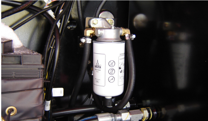
B. Brandstoffilter – Deutz TD.9 (op hydraulische tank)
